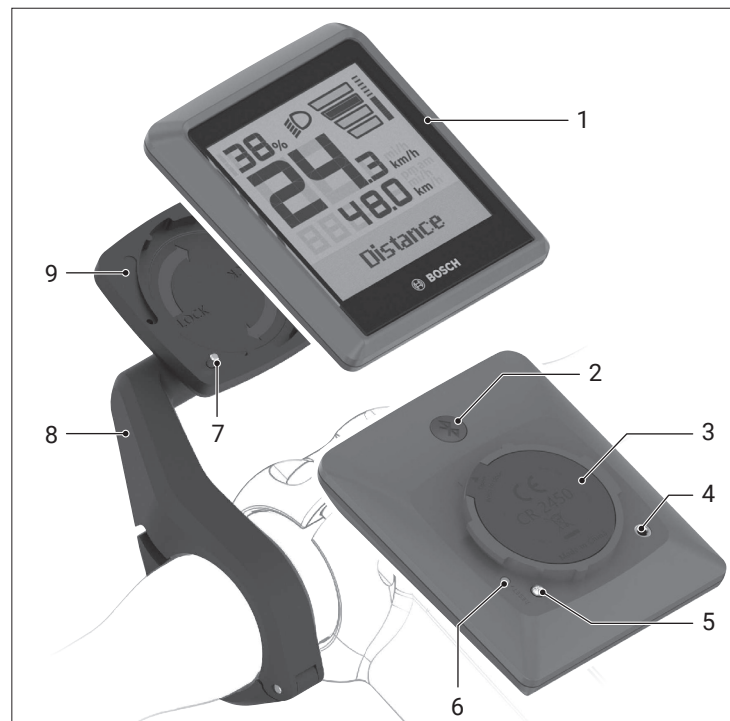
Fig. : 27 Ordinateur de commande Intuvia 100
