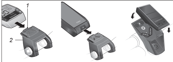
Abb. Einsetzen des Bediencomputers „ActiveLine“, „PerformanceLine“ bzw. „Nyon“ oder „Kiox“
