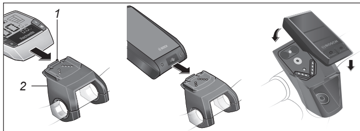
Afb. Plaatsen van de bedieningscomputer "ActiveLine", "PerformanceLine" resp. "Nyon" of "Kiox"
