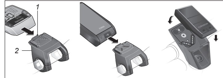
Abb. Einsetzen des Bediencomputers „ActiveLine“, „PerformanceLine“ bzw. „Nyon“ oder „Kiox“
