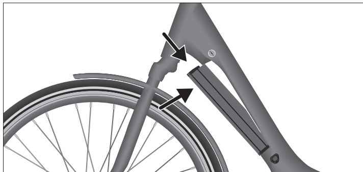
Abb. Tube Rahmenakku einsetzen
