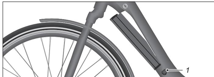
Abb. Ladebuchse Tube Rahmenakku
