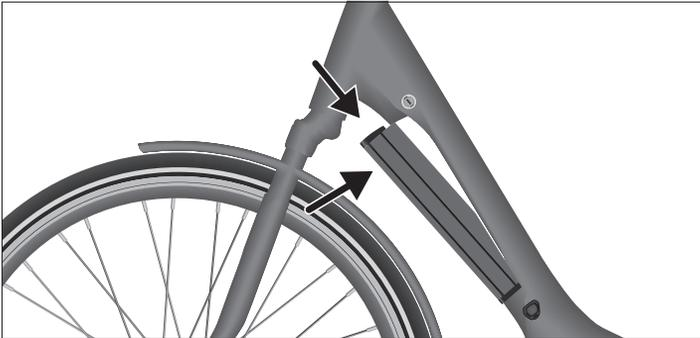
Abb. Tube Rahmenakku einsetzen
