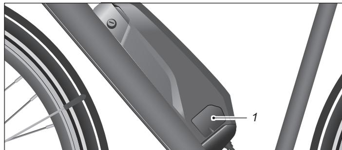
Abb. Ladebuchse Rahmenakku
