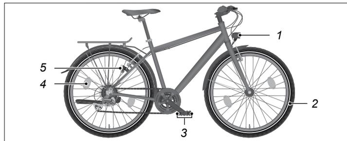
Fig. : Équipement d'éclairage (exemple)
