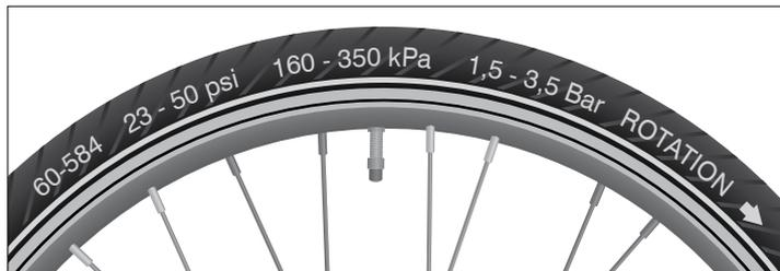
Fig. : Impression du flanc du pneu (exemple)
