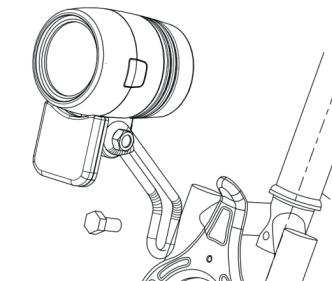
Scheinwerfer 1 mittels Stahlhalterung 5 am Fahrrad befestigen und darauf achten, dass sich der Scheinwerfer 1 nicht von allein wieder verstellt kann (Schraube fest genug anziehen!).
