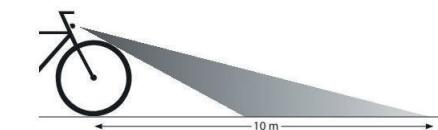
Richten Sie den Scheinwerfer so aus, dass der Lichtkegel bis ca. 10 Meter vor dem Rad auf die Fahrbahn reicht (siehe Abbildung).
