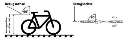
**Achtung!** Überprüfen Sie regelmäßig die richtige Einstellung und Anbauhöhe Ihres Rücklichtes. Das Rücklicht muss in einem Bereich von 250 bis 1200 mm über der Fahrbahn montiert werden. Es muss so angebaut und eingestellt werden, dass die Bezugsachse parallel zur Fahrzeuglängsmittelebene und parallel zur Fahrbahn liegt (siehe Abbildung).
