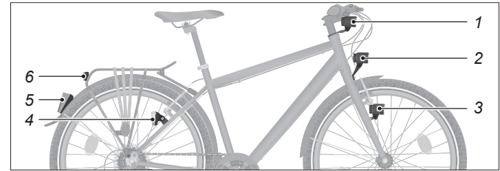
Abb. Montageorte der Beleuchtungsausstattung
