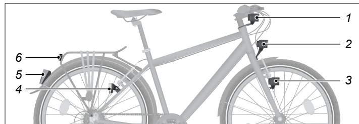
Fig.: Puntos de montaje del equipamiento de iluminación
